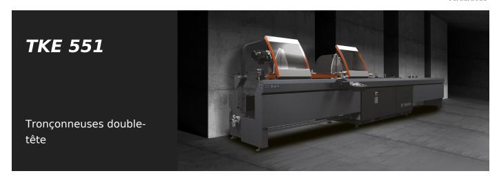
Tronçonneuse à double tête électronique, mouvement automatique de la tête mobile grâce à un moteur brushless à commande numérique par calculateur. Inclinaison pneumatique des unités de coupe à 90° jusqu'à 22°30' (externe) avec un système mécanique de réglage des angles intermédiaires. Avancement oléopneumatique de la lame.
