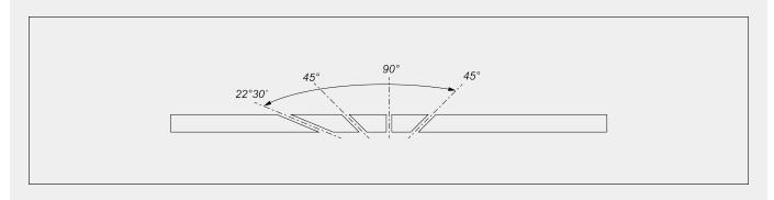
Réglage mécanique des angles intermédiaires
