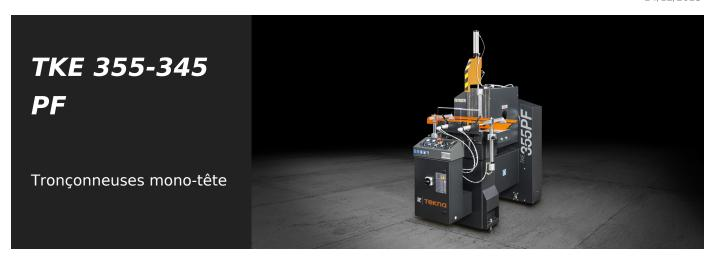
Tronçonneuse simple tête à lame frontale, côté de chargement sur la gauche et double pivotement latéral à commande pneumatique en positions fixes : 45° gauche et 90°, 45° et 22°30' droite. Une butée mécanique spécifique assure également la coupe à des angles intermédiaires.
