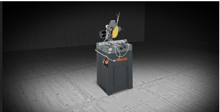
Tronçonneuse simple tête à lame descendante avec côté de chargement sur la gauche, rotation de l'unité de coupe à 45° (droite et gauche) et pivotement manuel à 45° par rapport à l'axe horizontal.
