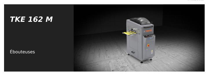
Ébouteuse horizontale à avance manuelle. Fraisage hors équerre 45° / 90° / -45°. Vitesse de rotation outil élevée pour améliorer la qualité de l'usinage sur le profilé peint et hors équerre. Changement rapide du groupe fraises avec commande pneumatique. Plan d'usinage anti-rayures. Zone d'usinage avec protection intégrale à haute visibilité interne.
