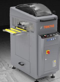
Ébouteuse horizontale à avance manuelle. Fraisage hors équerre 45° / 90° / -45°. Vitesse de rotation outil élevée pour améliorer la qualité de l'usinage sur le profilé peint et hors équerre. Changement rapide du groupe fraises avec commande pneumatique. Plan d'usinage anti-rayures. Zone d'usinage avec protection intégrale à haute visibilité interne.
