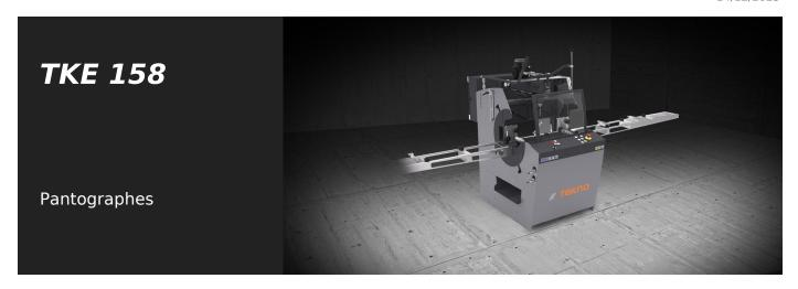
Pantographe à tête simple à commande manuelle avec blocage pneumatique et mouvement de translation de la tête à travers un levier indirect. Vitesse de rotation de l'outil modifiable par variateur électronique pour permettre les usinages sur l'acier jusqu'à 2 mm et pour améliorer la qualité des fraisages et la durée de vie de l'outil. Possibilité d'effectuer des usinages passants sur aluminium sans tourner la pièce. Plan de travail anti-rayure. Palpeur à commande manuelle.
