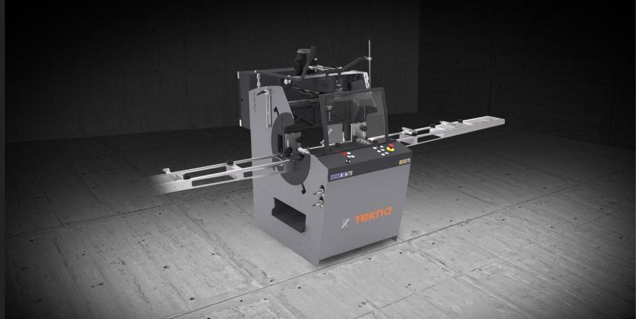
Pantographe à tête simple à commande manuelle avec blocage pneumatique et mouvement de translation de la tête à travers un levier indirect. Vitesse de rotation de l'outil modifiable par variateur électronique pour permettre les usinages sur l'acier jusqu'à 2 mm et pour améliorer la qualité des fraisages et la durée de vie de l'outil. Possibilité d'effectuer des usinages passants sur aluminium sans tourner la pièce. Plan de travail anti-rayure. Palpeur à commande manuelle.
