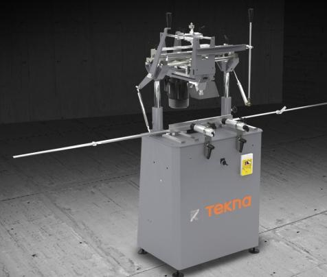
Pantographe monotête à commande manuelle disposant d'une large course en hauteur et d'un mouvement de translation de la tête au moyen d'une poignée ou d'un levier indirect. Possibilité de réaliser des usinages débouchants sans tourner la pièce. Palpeur à commande manuelle.
