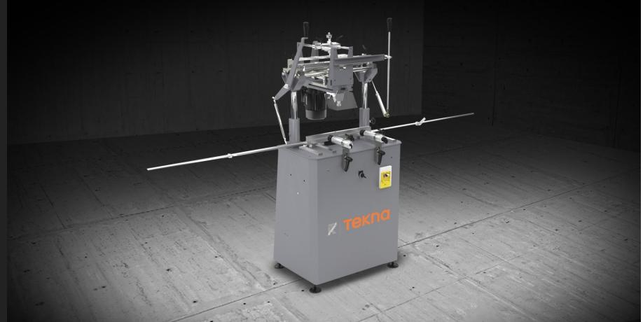
Pantographe monotête à commande manuelle disposant d'une large course en hauteur et d'un mouvement de translation de la tête au moyen d'une poignée ou d'un levier indirect. Possibilité de réaliser des usinages débouchants sans tourner la pièce. Palpeur à commande manuelle.
