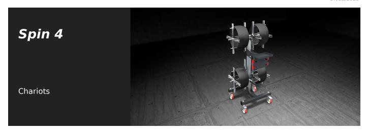
Dévidoir à joint. Un dévidoir avec frein et un guide-fil assurent le débobinage sans encombre du joint. Equipé d'un système de changement rapide des bobines.
