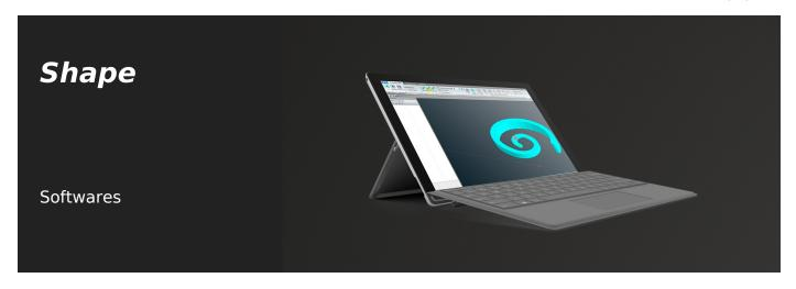
Shape est un logiciel permettant de créer librement des figures de toutes formes: lignes, arcs, orifices. Possibilité d'importer des figures au format DXF. L'affichage en 3D permet de mieux suivre les figures lorsque la profondeur n'est pas constante. Shape permet d'obtenir plus rapidement des usinages qui auraient dû passer par la composition de figures «standard».
