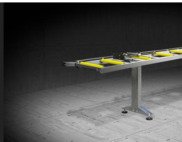
Structure en éléments tubulaires d'acier avec pieds réglables et rouleaux en acier revêtus en PVC. Rouleaux de 240 mm, la longueur du chemin atteint 3.500 mm ou avec des rouleaux de 440 mm, la longueur du chemin est de 4.000 mm.
