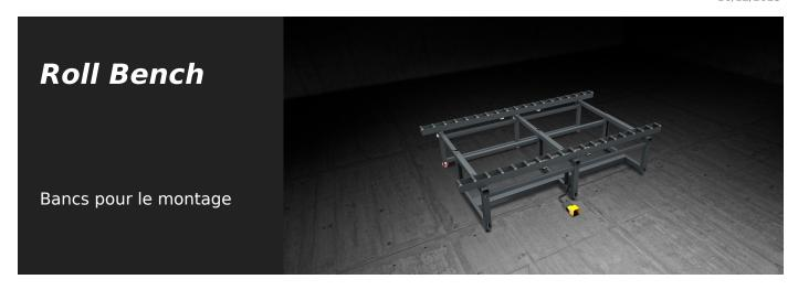
Table modulaire de grandes dimensions conçue pour le montage et la manutention en ligne de cadres de murs-rideaux. Equipée de deux chemins d'amenage recouverts d'une gaine en PVC souple; le réglage de la distance entre les deux chemins d'amenage est fonction de la largeur de la pièce. Un système à actionnement pneumatique permet de bloquer les rouleaux durant les phases de travail.
