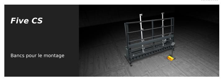
Table d'essai pour menuiseries en aluminium. Elle permet de recréer les conditions d'utilisation du châssis de menuiserie : le châssis est bloqué par un système d'étaux réglables sur toute sa hauteur, les ouvrants sont introduits à l'intérieur du châssis et on réalise le vitrage et l'essai final. Le chemin d'amenage permet à l'opérateur de charger et de décharger des menuiseries volumineuses de façon parfaitement autonome.
