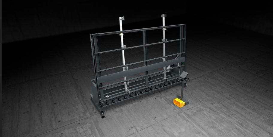
Table d'essai pour menuiseries en aluminium. Elle permet de recréer les conditions d'utilisation du châssis de menuiserie : le châssis est bloqué par un système d'étaux réglables sur toute sa hauteur, les ouvrants sont introduits à l'intérieur du châssis et on réalise le vitrage et l'essai final. Le chemin d'aménage permet à l'opérateur de charger et de décharger des menuiseries volumineuses de façon parfaitement autonome.
