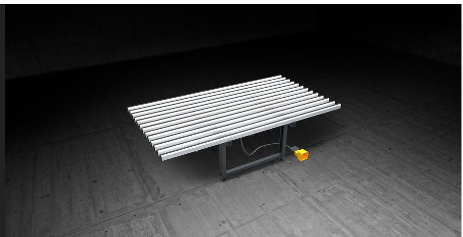
Table pour l'assemblage d'ouvrants et de châssis. Table horizontale avec échange pneumatique entre la surface d'appui en PVC souple (pour la phase d'assemblage) et la surface d'appui en PVC dur antifriction (pour la phase de déplacement). La hauteur du plan d'usinage est réglable entre 895 et 965 mm et les pieds sont percés pour l'ancrage au sol.
