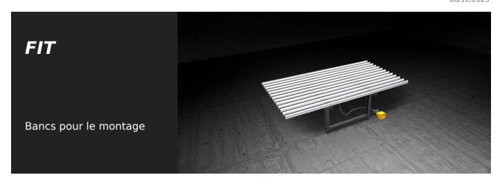
Table pour l'assemblage d'ouvrants et de châssis. Table horizontale avec échange pneumatique entre la surface d'appui en PVC souple (pour la phase d'assemblage) et la surface d'appui en PVC dur antifriction (pour la phase de déplacement). La hauteur du plan d'usinage est réglable entre 895 et 965 mm et les pieds sont percés pour l'ancrage au sol.
