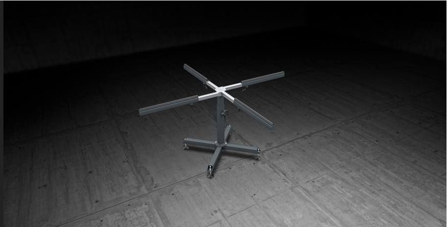
Table pour l'assemblage d'accessoires et de joints. Pivotant sur un point d'appui central, elle est extensible en longueur de façon à pouvoir faire tourner le cadre.
