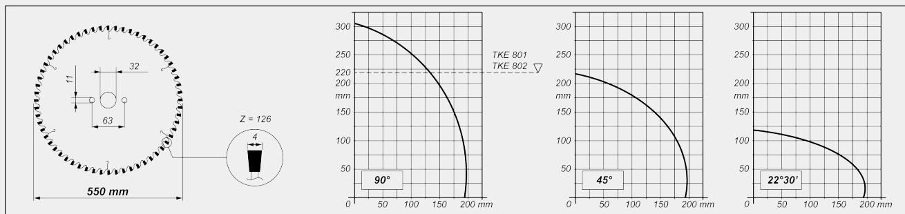
**INCLINACIÓN CABEZAL DE CORTE**
