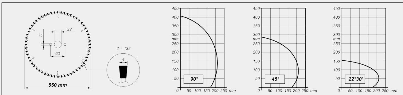
**INCLINACIÓN CABEZAL DE CORTE**
