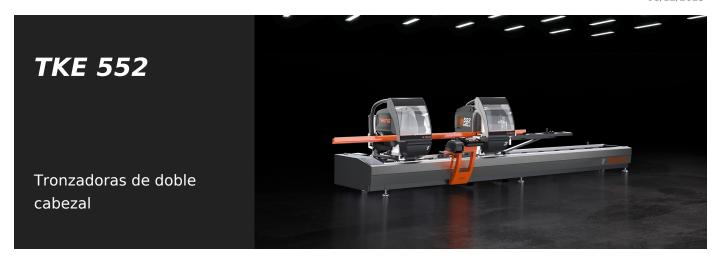
Tronzadora de doble cabezal electrónica con movimiento automático del cabezal móvil mediante motor brushless accionado por un control numérico. Inclinación neumática de los cabezales de corte de 90° hasta 22°30′ (externa) en dos posiciones fijas o con sistema opcional mecánico de regulación de los ángulos intermedios. Avance disco oleoneumático.
