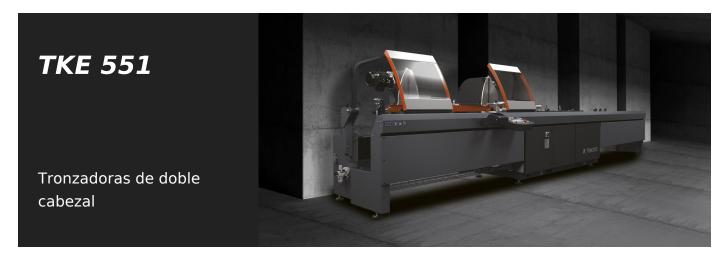
Tronzadora de doble cabezal electrónica con movimiento automático del cabezal móvil mediante motor brushless accionado por un control numérico. Inclinación neumática de las unidades de corte de 900 hasta 220 30' (externa) con sistema mecánico de regulación de los ángulos intermedios. Avance disco aceite-neumático.
