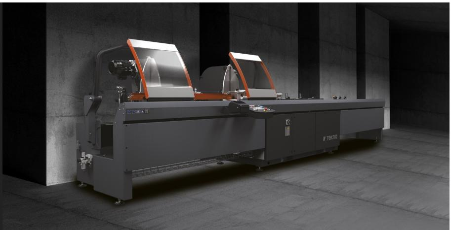
Tronzadora de doble cabezal electrónica con movimiento automático del cabezal móvil mediante motor brushless accionado por un control numérico. Inclinación neumática de las unidades de corte de 90° hasta 22° 30' (externa) con sistema mecánico de regulación de los ángulos intermedios. Avance disco aceite-neumático.
