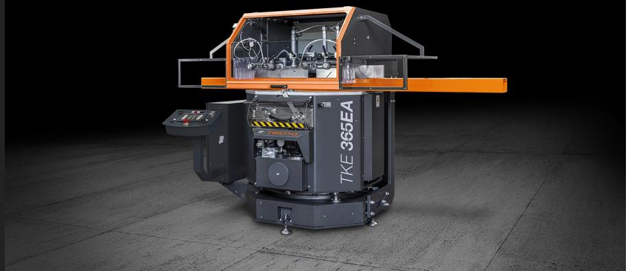
Tronzadora con una unidad de corte ascendente, rotación automática - con control numérico - del eje vertical por medio de un motor brushless e inversión simultánea del eje horizontal accionada hidráulicamente. Permite efectuar cortes en angulaciones de 90° a 22°30' (a la izquierda y a la derecha) en el eje vertical y de 90° a 35° (sólo a la derecha) en el eje horizontal.
