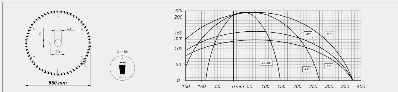
**INCLINACIÓN CABEZAL DE CORTE**
