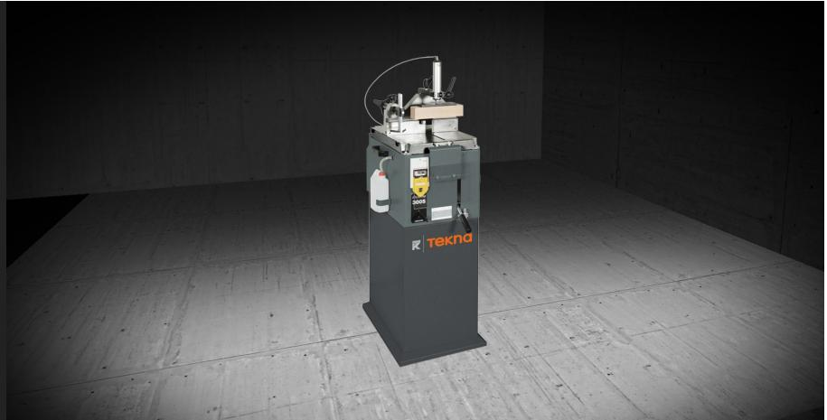
Tronzadora monocabezal ascendente para efectuar cortes a 90°, 45° (a la derecha y a la izquierda) y en angulaciones intermedias.
