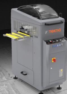
Retestadora horizontal de avance manual. Fresado fuera de escuadra +45° / 90° / -45°. Alta velocidad de rotación herramienta para mejorar la calidad del mecanizado en el perfil pintado y fuera de escuadra. Cambio rápido del grupo fresas con mando neumático. Plano de mecanizado anti-rayas. Zona de trabajo completamente carenada con amplia visibilidad interna.
