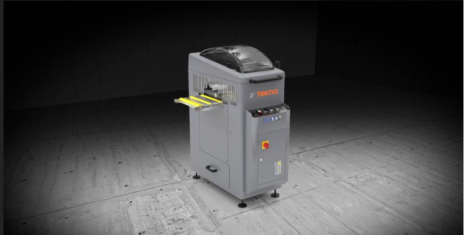
Retestadora horizontal de avance manual. Fresado fuera de escuadra +45° / 90° / -45°. Alta velocidad de rotación herramienta para mejorar la calidad del mecanizado en el perfil pintado y fuera de escuadra. Cambio rápido del grupo fresas con mando neumático. Plano de mecanizado anti-rayas. Zona de trabajo completamente carenada con amplia visibilidad interna.
