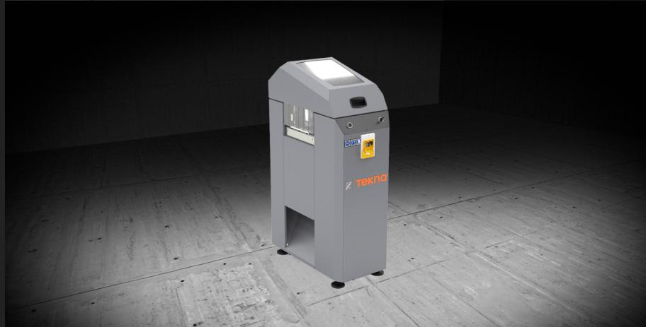
Fresadora retestadora horizontal con avance manual. Fresado en escuadra de 90°. Cambio rápido del grupo de fresas con mando de palanca. Plano de apoyo perfil antirrayas. Zona de mecanizado protegida integralmente.
