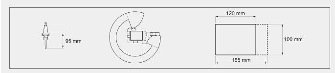
Sección máxima mecanizable en 4 caras - L x H (mm) 120 x 100
