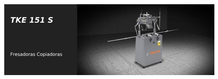
TKE 151 S es una fresadora copiadora de una unidad de fresado con bajada manual, amplia carrera en altura y traslación de la unidad por medio de palanca indirecta. Posibilidad de realizar mecanizados pasantes sin girar la pieza. Palpador de mando manual.
