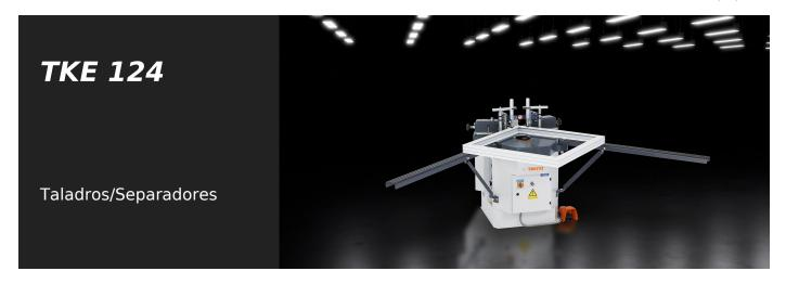
Achaflanadora neumática para el prensado de perfiles de grandes dimensiones y fachadas estructuradas, con elevados requisitos de calidad. Sus principales ventajas son: la facilidad de configuración y uso, con tiempos de puesta a punto y regulación reducidos al mínimo; la robustez extrema de la estructura que ofrece alta precisión a la elaboración, la gran fuerza de prensado que suministra un cilindro de fuelle de elevado volumen que no requiere mantenimiento.
