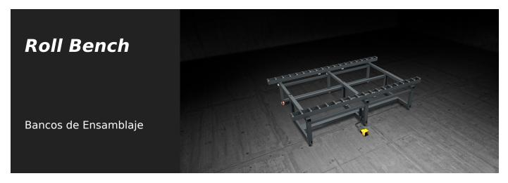
Banco modular de gran tamaño para el ensamblaje y el desplazamiento en línea de módulos de fachadas. Se suministra con dos bases de rodillos recubiertas de PVC blando. La distancia entre las dos bases puede regularse en función de las dimensiones de la carpintería. Un sistema, que se acciona neumáticamente, permite bloquear los rodillos durante las fases de trabajo.
