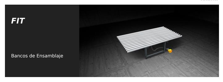
Banco para ensamblar hojas y marcos. Banco horizontal con intercambio neumático entre el plano de apoyo de PVC blando (para la fase de montaje) y el plano de apoyo de PVC rígido antifricción (para la fase de manipulación). Se puede regular la altura del plano de apoyo de 895 a 965 mm y sus pies tienen agujeros para poder fijarse al suelo.
