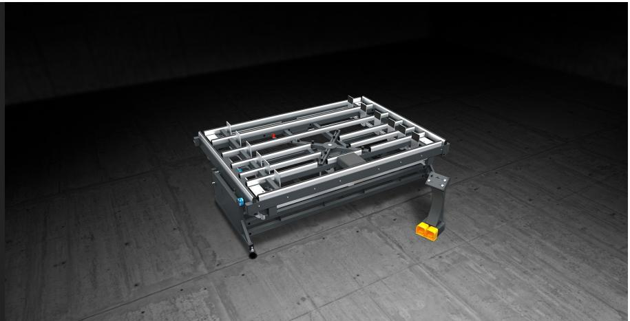
Banco para el ensamblaje del marco de aluminio con la goma u el cristal. El cristal se levanta mediante una cruceta y, con el empleo de un sistema de mordazas autoalineantes, los marcos se prensan sobre el cristal, de dos en dos. Tras prensar el primer par de lados, la cruceta se hace girar y se repiten las mismas operaciones de prensado sobre los restantes lados.
