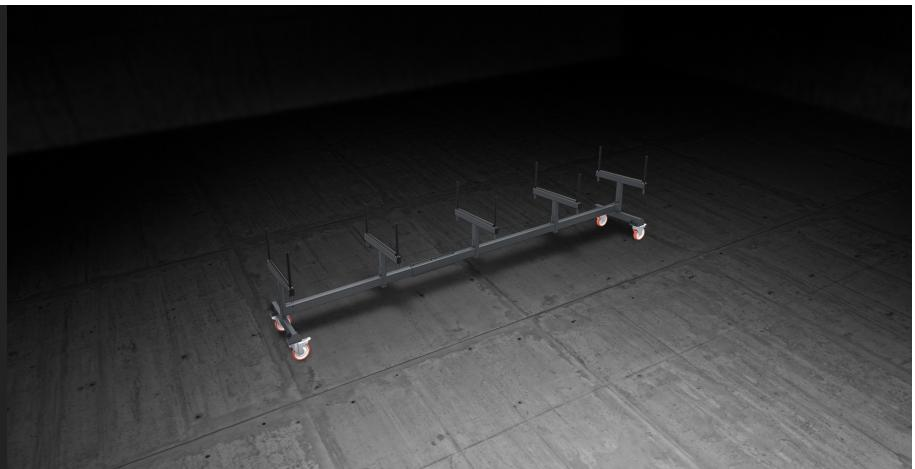
Carro de grandes dimensiones para transportar y almacenar barras de perfil durante el corte.
