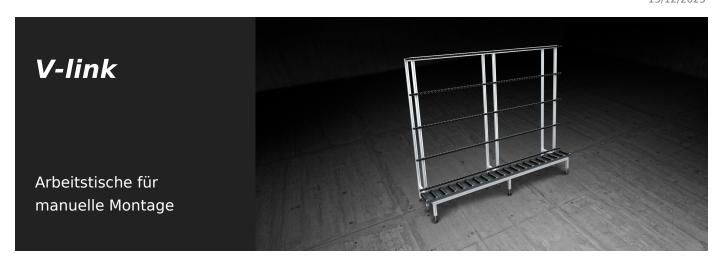
Vertikale Rollenbahn für den extrem einfachen Transport zwischen verschiedenen Montagestationen von Rahmen sowie Tür- und Fensterelementen, einschließlich sehr schwerer Teile.
