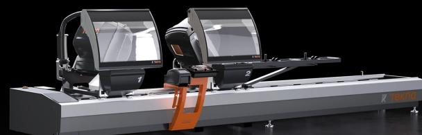
Doppelgehrungssäge mit 3 gesteuerten Achsen mit automatisch verfahrbarem Kopf und elektronischem Management aller Winkel im Bereich zwischen 22°30' außen bis 45° innen. Der Vorschub der beiden Sägeblätter mit 550 mm erfolgt mittels ölpneumatischen Zylindern.
