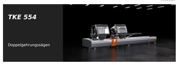
Doppelgehrungssäge mit 3 gesteuerten Achsen mit automatisch verfahrbarem Kopf und elektronischem Management aller Winkel im Bereich zwischen 22°30' außen bis 45° innen. Der Vorschub der beiden Sägeblätter mit 550 mm erfolgt mittels ölpneumatischen Zylindern.
