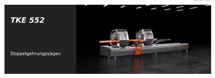
Elektronische Doppelgehrungssäge mit mittels NC-gesteuertem Brushless-Motor automatisch verfahrbarem Sägeaggregat. Pneumatisch gesteuerte Neigung der Sägeaggregate von 90° auf 22°30′ (nach außen) auf zwei festen Positionen oder mit einem optionalen mechanischem Einstellsystem der Zwischenwinkel. Hydropneumatischer Sägeblattvorschub.
