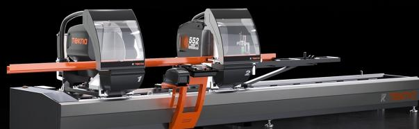
Elektronische Doppelgehrungssäge mit mittels NC-gesteuertem Brushless-Motor automatisch verfahrbarem Sägeaggregat. Pneumatisch gesteuerte Neigung der Sägeaggregate von 90° auf 22°30' (nach außen) auf zwei festen Positionen oder mit einem optionalen mechanischen Einstellsystem der Zwischenwinkel. Hydropneumatischer Sägeblattvorschub.
