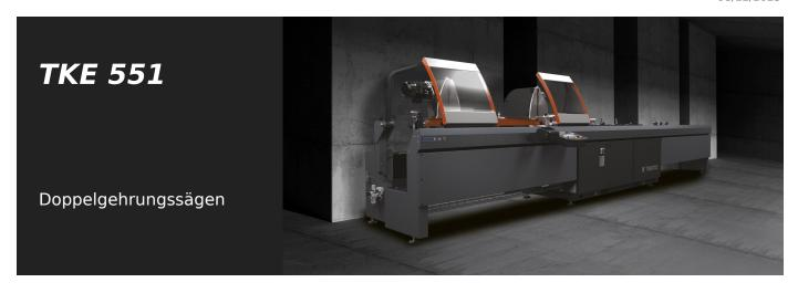
Elektronische Doppelgehrungssäge mit mittels NC-gesteuertem Brushless-Motor automatisch verfahrbarem Sägeaggregat. Pneumatisches Neigen der Schneideeinheiten von 90° bis 22°30′ (außen) mit mechanischem System zur Einstellung der dazwischen liegenden Gehrungswinkel. Hydropneumatischer Sägeblattvorschub.
