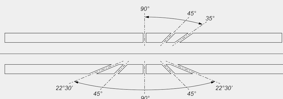
Elektronische Einstellung der Zwischenwinkel auf vertikaler Achse
