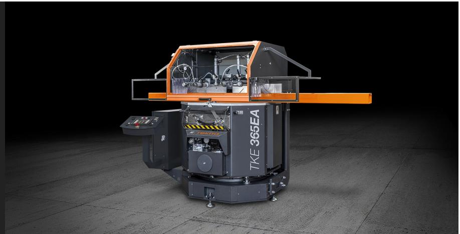
Schifterschnittsäge mit von unten kommendem Sägeblatt und automatischer CNC-gesteuerter Drehung um die vertikale Achse über Gleichstrommotor mit gleichzeitiger hydraulischer Drehung um die horizontale Achse. Gehrungsschnitte von 90° bis 22°30' (links und rechts) auf der vertikalen Achse und von 90° bis 35° (nur rechts) auf der horizontalen Achse (nur rechts).
