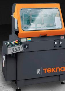
Unterflurkreissäge, Zufahrtsseite links, für 20° Gehrungen links bis 20° Gehrungen rechts sowie Zwischengehrungen.
