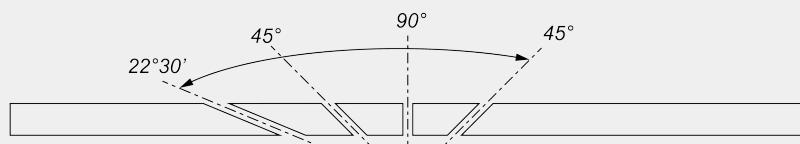
Mechanische Einstellung der Zwischenwinkel
