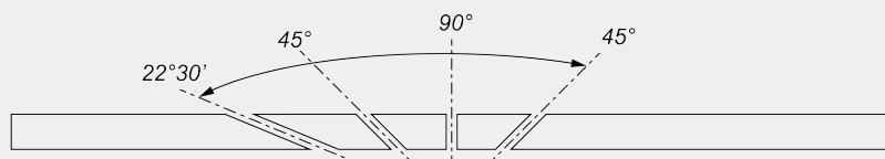
Mechanische Einstellung der Zwischenwinkel
