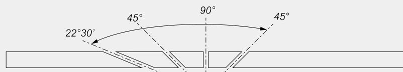
Mechanische Einstellung der Zwischenwinkel
