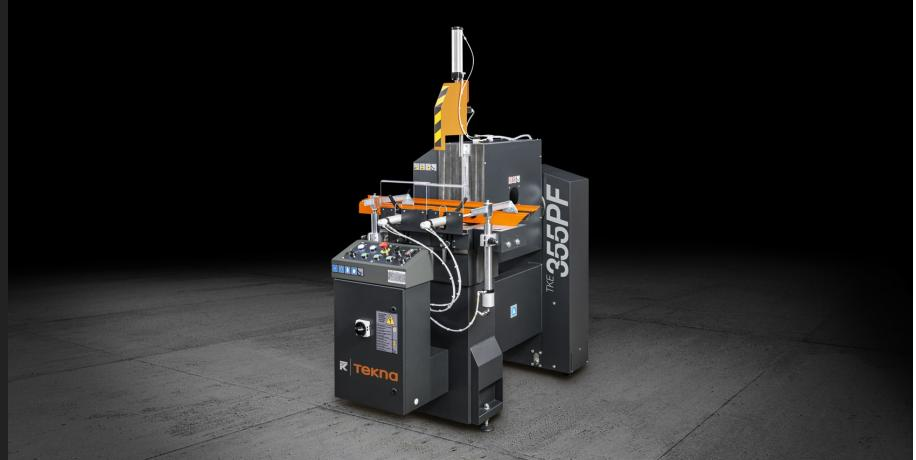
Gehrungssäge mit nach vorne ausfahrendem Sägeblatt, Zufuhrseite links; horizontales pneumatisches Schwenken auf feste Gehrungswinkel: links 45° und 90°, rechts 45° und 22°30'. Ein spezieller mechanischer Anschlag ermöglicht auch das Schneiden von Zwischengehrungen.
