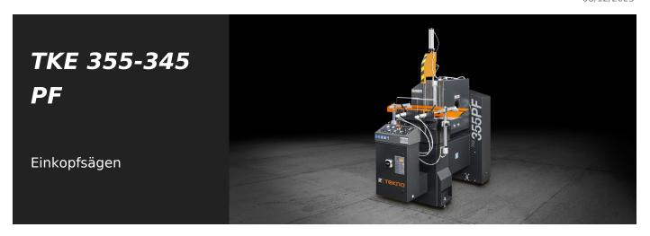
Gehrungssäge mit nach vorne ausfahrendem Sägeblatt, Zufuhrseite links; horizontales pneumatisches Schwenken auf feste Gehrungswinkel: links 45° und 90°, rechts 45° und 22°30′. Ein spezieller mechanischer Anschlag ermöglicht auch das Schneiden von Zwischengehrungen.
