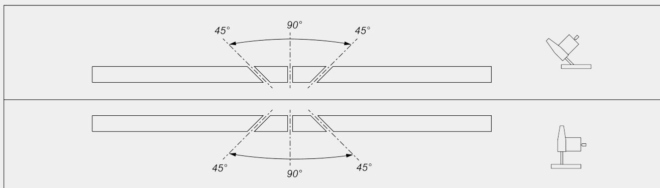
Mechanische Einstellung der Zwischenwinkel
