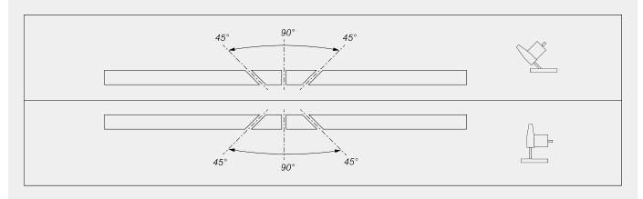
Mechanische Einstellung der Zwischenwinkel
