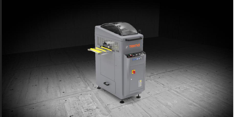
Horizontale Ausklinkfräse mit manuellem Vorschub. Nicht rechtwinklige Fräsbearbeitung +45° / 90° / -45°. Hohe Werkzeugdrehgeschwindigkeit zur Verbesserung der Verarbeitungsqualität an lackierten und nicht rechtwinkligen Profilen. Schnellwechselvorrichtung des Frässystems mit pneumatischer Steuerung. Kratzfester Arbeitstisch. Arbeitsbereich mit Volumenhäusung, die gute Sichtbereich in den Innenbereich bietet.
