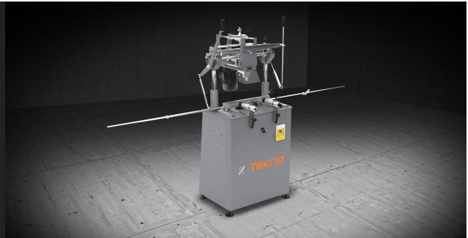
Die TKE 151 S ist eine Einspindel-Kopierfräse mit manueller Betätigung mit großem vertikalem Verfahrweg. Das Verfahren des Fräskopfs erfolgt mittels Griff oder über Umlenkhebel. Möglich ist die Durchführung von durchgehenden Bearbeitungen, ohne das Werkstück zu drehen. Manueller Kopierbolzen.
