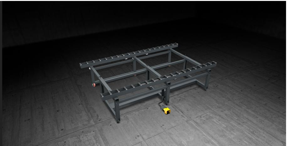
Großer Montagetisch mit modularem Aufbau für Montage und Inline-Handling von Fassadenelementen. Der Montagetisch ist mit zwei Rollenbahnen mit Überzug aus weichem PVC ausgestattet, deren Abstand je nach Breite des Werkstücks verstellt werden kann. Mithilfe eines pneumatischen Klemmsystems werden die Rollen während der Bearbeitungsphasen geklemmt.
