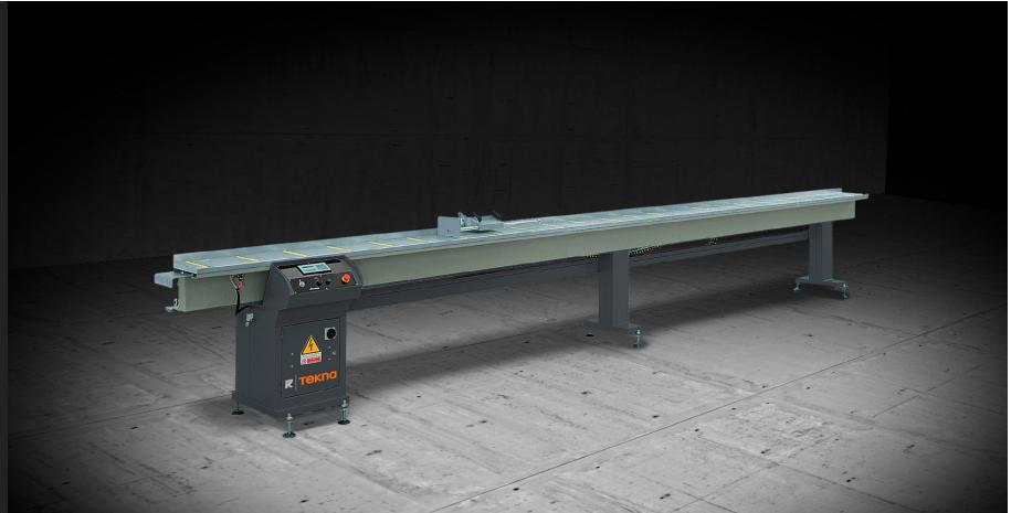
Profilaufage und Längenmesssystem mit motorischer Verfahrung über Gleichstrommotor und elektronischer Längenmaß erfassung durch Drehgeber.
