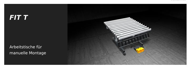
Montagetisch für alle Montagearbeiten von Flügeln und Rahmen. Arbeitstisch schwenkbar von 0° (waagrecht) bis 85°. Pneumatischer Wechsel zwischen einer Ablageplatte aus weichem PVC (für die Bearbeitungsphase) und einer Ablageplatte aus kratzfesten hartem PVC (für die Handlingphase). Rollenbahn manuell kippbar und unabhängig von der Arbeitsplatte höhenverstellbar (170 mm bis 460 mm). Arbeitsplatte höhenverstellbar von 895 mm bis 965 mm. Füße mit Löchern zu Verankerung am Boden.
