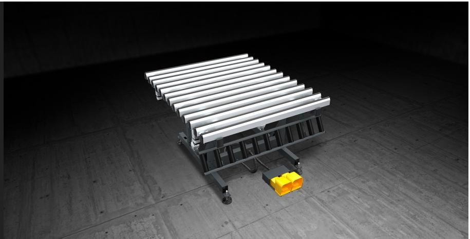
Montagetisch für alle Montagearbeiten von Flügeln und Rahmen. Arbeitstisch schwenkbar von 0° (waagrecht) bis 85°. Pneumatischer Wechsel zwischen einer Ablageplatte aus weichem PVC (für die Bearbeitungsphase) und einer Ablageplatte aus kratzfesten hartem PVC (für die Handlingphase). Rollenbahn manuell kippbar und unabhängig von der Arbeitsplatte höhenverstellbar (170 mm bis 460 mm). Arbeitsplatte höhenverstellbar von 895 mm bis 965 mm. Füße mit Löchern zu Verankerung am Boden.
