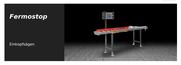
Profilauflage und Längenanschlag mit Verfahrbewegung des Abschlags auf CN-Achse und elektronische Erfassung über einen Absolut-Magnetstreifen. Mit einem elektronischen Messsystem ausgestattet, das es ermöglicht, die Daten im internen Speicher zu speichern oder über Bluetooth in Echtzeit an einen PC oder die Steuerung einer Kappsäge zu übertragen. Ermöglicht hoch präzise Bearbeitungen und die Wiederholbarkeit der Positionierung.
